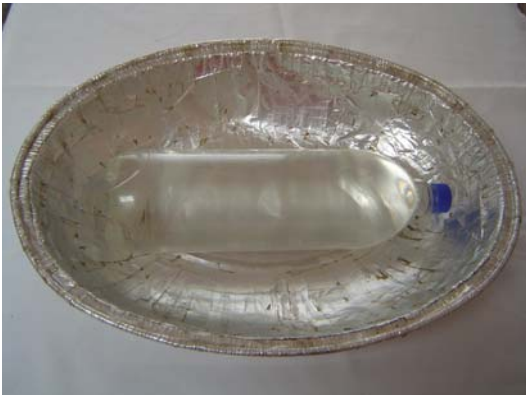
Fotografía 4: Reflector solar, tipo 2
